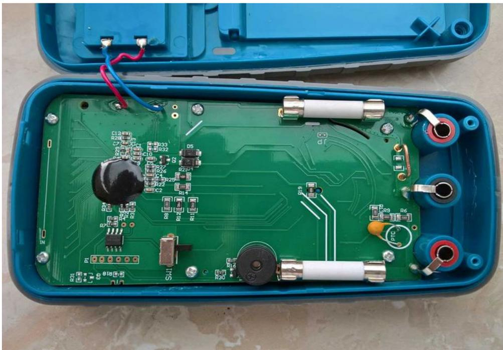
Dies erkennt man auch an dem inneren Aufbau mit nur wenigen Bauelementen. Die Sicherungen sind für die Strombereiche. Der keine Bügel aus Kupfer ist wohl der 10A Widerstand. Wofür der interne Schalter ist, keine
