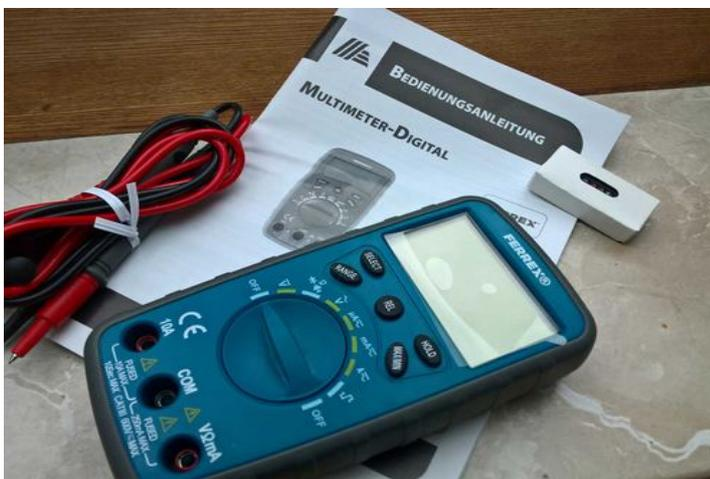
Die geringste Messunsicherheit, die oft bei DVMs angegeben wird, ist hier bei Gleichspannung im 100mV Bereich: 0,5%+5 Digit. Dies reicht für den Hausgebrauch voll aus.
