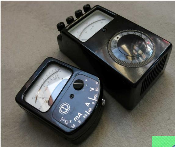
eines Weicheisenrings eine bewegliche Drehspule mit einem Dauermagneten. Die Bauweise ist so kompakter, aber wegen des inhomogenen Magnetfelds der Zeigerausschlag und damit die Skala nicht mehr linear. Diese Bauform wird als Kernmagnetsystem bezeichnet. Welche der beiden letzten Varianten hier verwendet wurden, konnte ich nicht ermitteln. Auch der hier verwendete Glaszeiger, der im vorderen Bereich schwarz eingefärbt ist, stellt eine Besonderheit dar.
