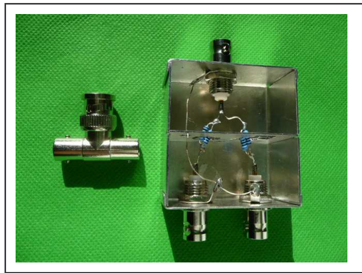
T-Stück und Power Splitter im Selbstbau
