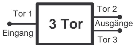
Distanz und auf Grund des mechanisch symmetrischen Aufbaus, dort elektrisch gleiche Spannungswerte anliegen. Durch die Bauform sind auch die inneren Leitungswiderstände, Induktivitäts- und Kapazitätswerte zu beiden Seitenarmen gleich. Dies bedeutet, dass an den Seitenarmen im Idealfall der Frequenzgang der Amplitude und der Phase gleich sind. Der Gleichlauf (Tracking) ist daher die
