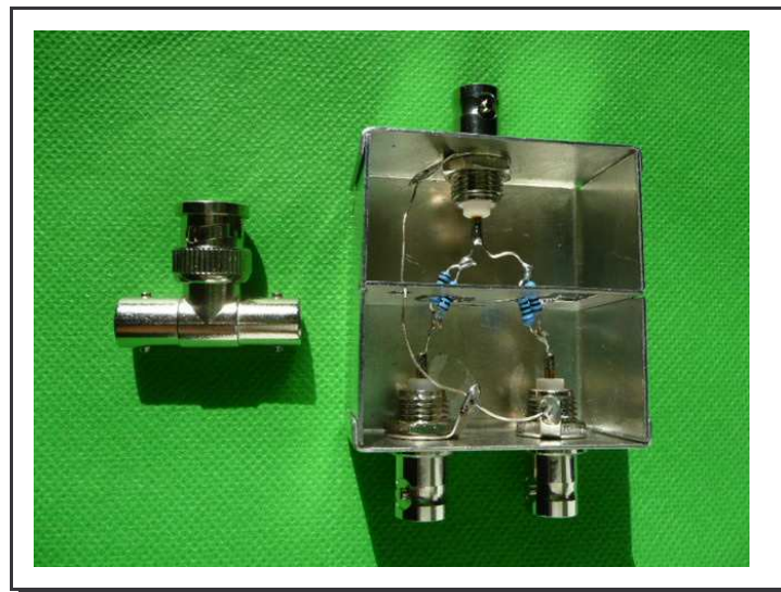
T-Stück und Power Splitter im Selbstbau
