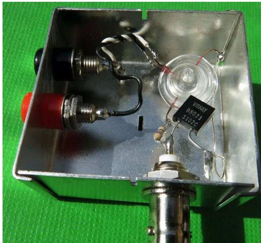
Grundsätzlich sind die hier beschriebenen Konverter nur sinnvoll bis maximal 150 MHz einzusetzen. Zu höheren Frequenzen steigen die Korrekturfaktoren und Messunsicherheiten zu sehr an. Schon ab 50 MHz sind die Spezifikationen bei Thermistoren und teils bei HF-Sensoren, auch beim Reflexionsfaktor, erheblich besser.
