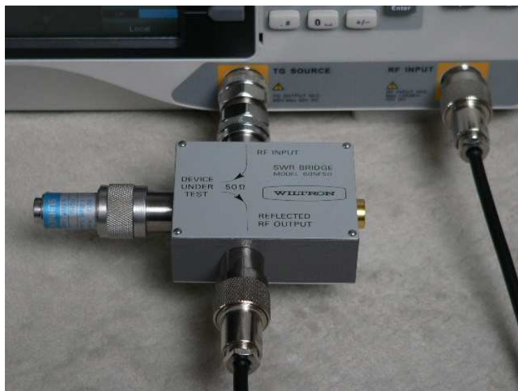
SWR-Brücke mit Load an einem Spektrumanalyser mit Generator
