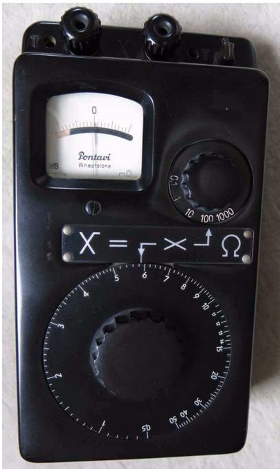
Abb.9 Einfache Widerstandsmessbrücke
