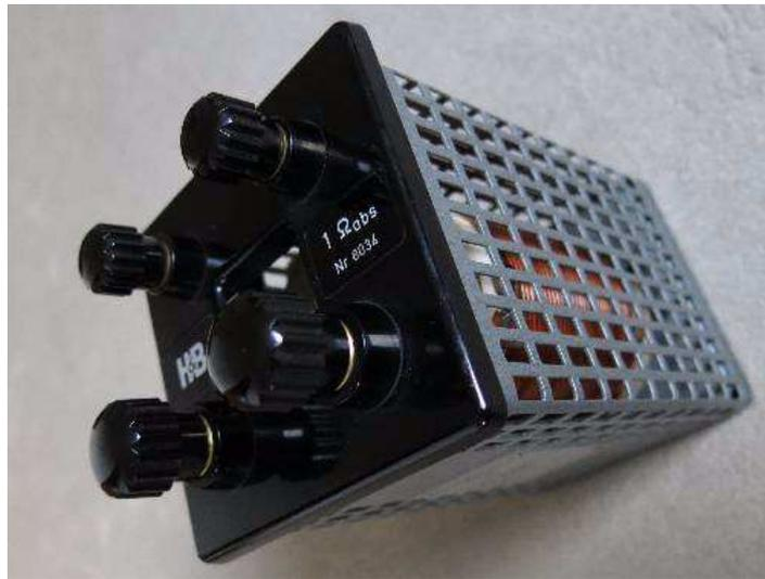
Abb. 5 Hartmann und Braun 1 Ohm Widerstand
