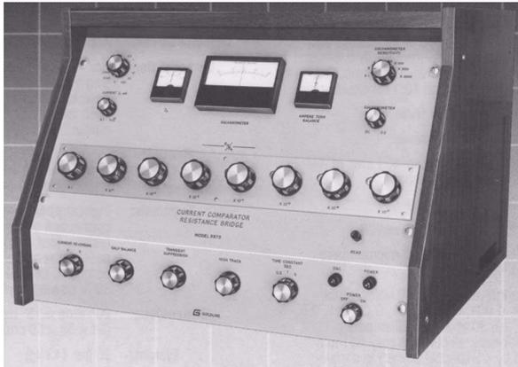
Abb.10 Comparator-Resistance-Bridge 9975
