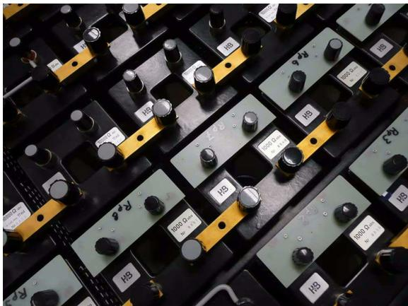
Abb.14 Ausschnitt Teiler mit Messlöchern für Stöpsle
